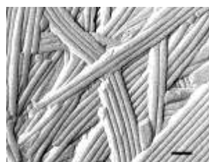
Fig. 2. MET de nanotubes formés par BHPB (cryofracture)
